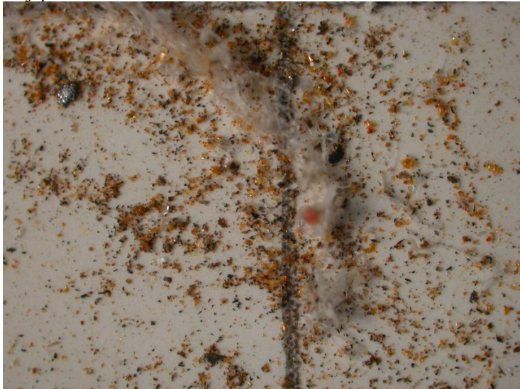
Bild av ny oljas föroreningar ovanpå 0.8 microns filterduk med 200x förstoring. Tot.Gravimet. 1.2mg/100ml Vattenhalt 180ppm
